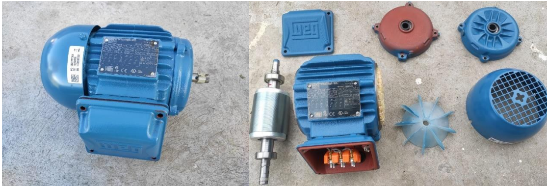
Figura 13. Desmontaje del motor trifásico jaula de ardilla.
