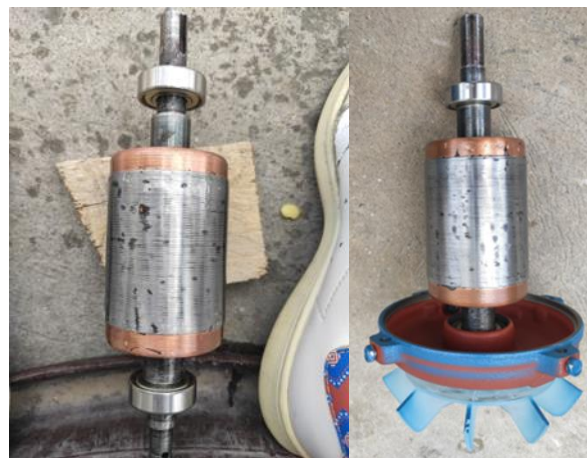
Figura 27. Colocación de los rodamientos y el ventilador de la MI.
