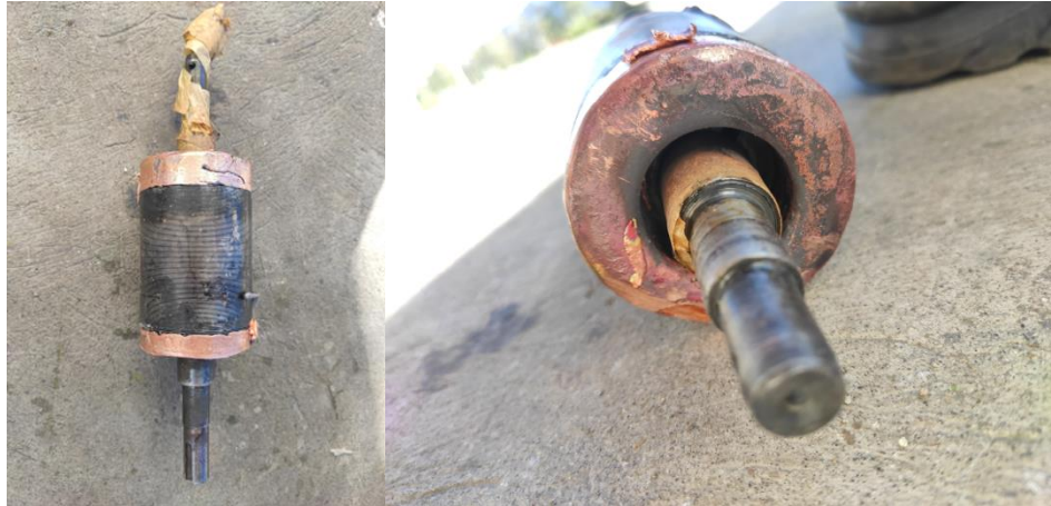
Figura 24. Resultado obtenido de la fundición del cobre en el rotor.
