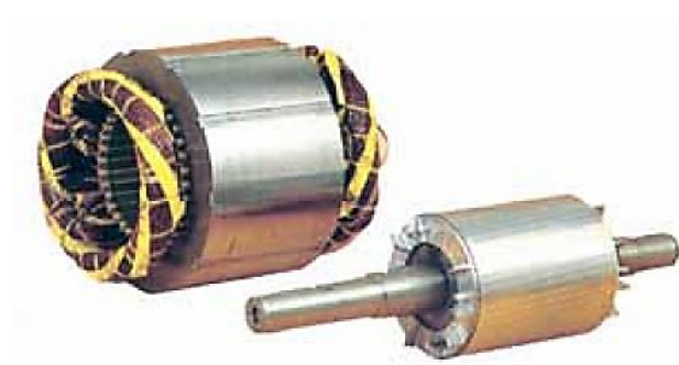
Figura 1. Estator y rotor de un motor de inducción trifásico jaula de ardilla [7].
