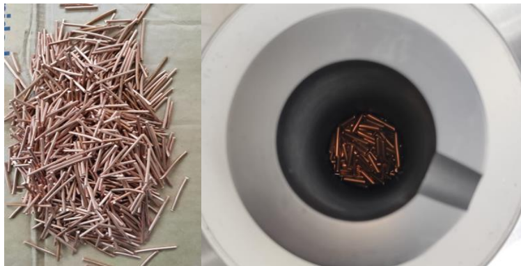
Figura 18. Deshilachado y colocación del cobre en el crisol.
