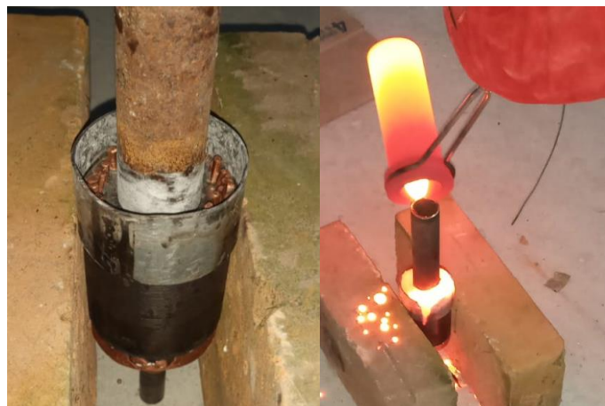
Figura 23. Fundición del segundo anillo de cortocircuito.
