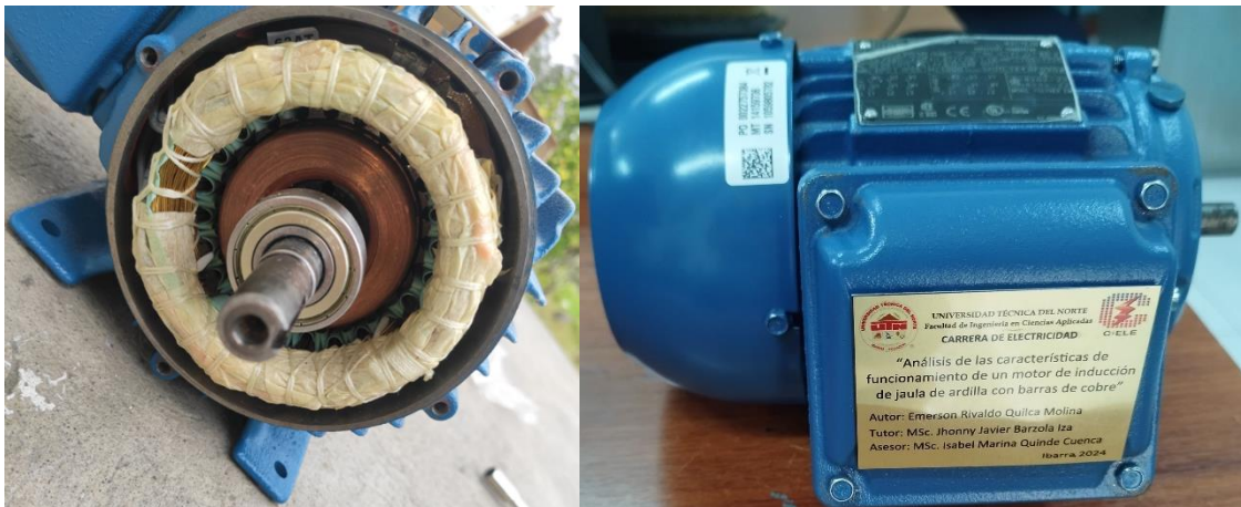
Figura 28. Ensamblado del motor de inducción jaula de ardilla con barras de cobre.
