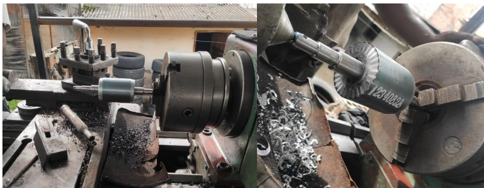
Figura 14. Retiro de los anillos de cortocircuito del rotor.
