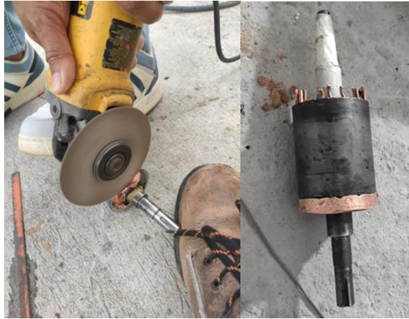
Figura 22. Resultado del primer anillo de cortocircuito.
