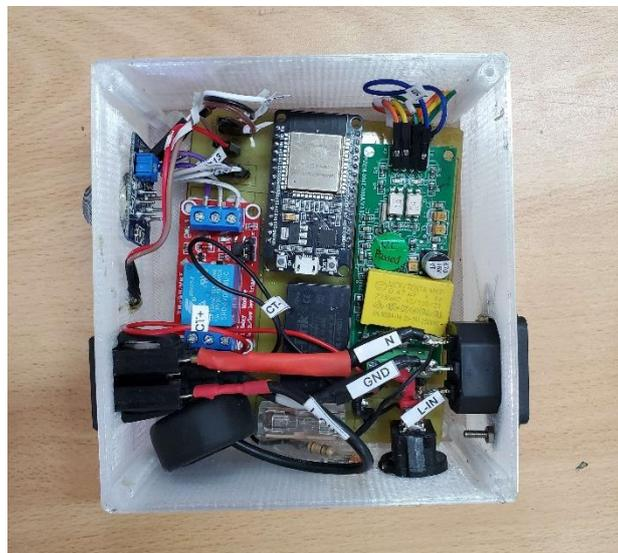
En la imagen de la Figura 19 observamos una caja similar al del Nodo 1, sin embargo, en el lateral izquierdo de la caja observamos el sensor MQ-2 sobresaliendo de la caja.
