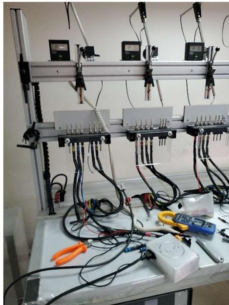
Se hicieron 2 pruebas de error, la primera con un factor de potencia de 1 y la segunda con 0,5. En la Figura 40 podemos observar los parámetros ingresados en la interfaz del equipo para la prueba con un factor de potencia de 1, en donde finalmente obtenemos un error de 0,12%, como se observa en la hoja de resultados de la Figura 41. La señal utilizada para ambas pruebas fue de 120VAC 60Hz a 5A.
