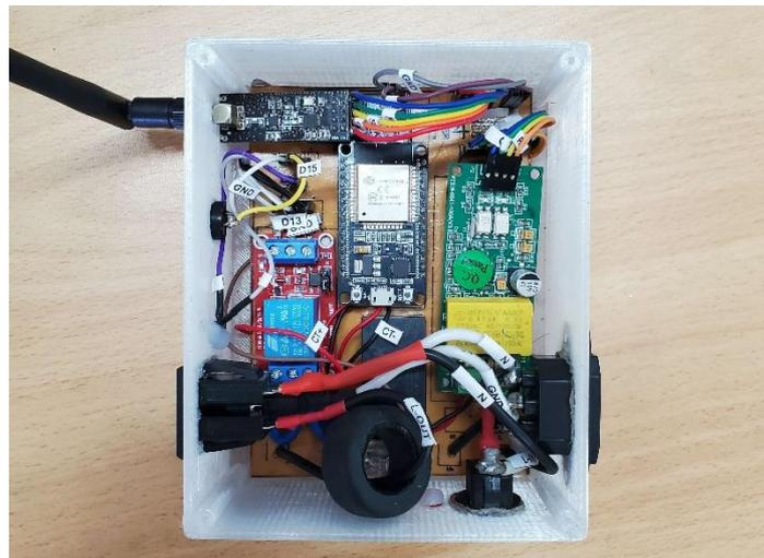
De esta manera, la antena queda sujeta a presión con la carcasa y es posible maniobrarla para cambiar su ángulo y dirección, como se observa en la Figura 25.
