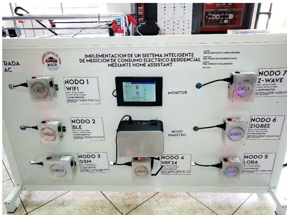
El tablero que se observa en la Figura 36 está conformado de una base de aloclubond de 1,6 m x 0,9 m y 3 mm de grosor, mientras que el marco que lo sostiene es de aluminio. Se utilizó los modelos 3D de los nodos y del monitor para la proyección del diseño el tablero usando Autodesk Fusion 360, para así mantener el espacio adecuado para el resto de elementos colocados posteriormente.
