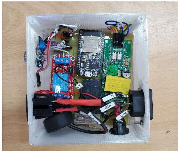
Como se observa en la Figura 16, se utilizó cable flexible de calibre 12 AWG como conductor del circuito de fuerza en el Nodo. También se conectaron los dispositivos externos a la PCB como el sensor DHT11 y los leds indicadores utilizando conectores.
