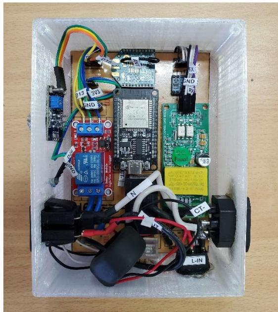
La Figura 30 nos muestra que también se expandió la caja de forma vertical para poder otorgarle el suficiente espacio a las conexiones del módulo Xbee S2C.
