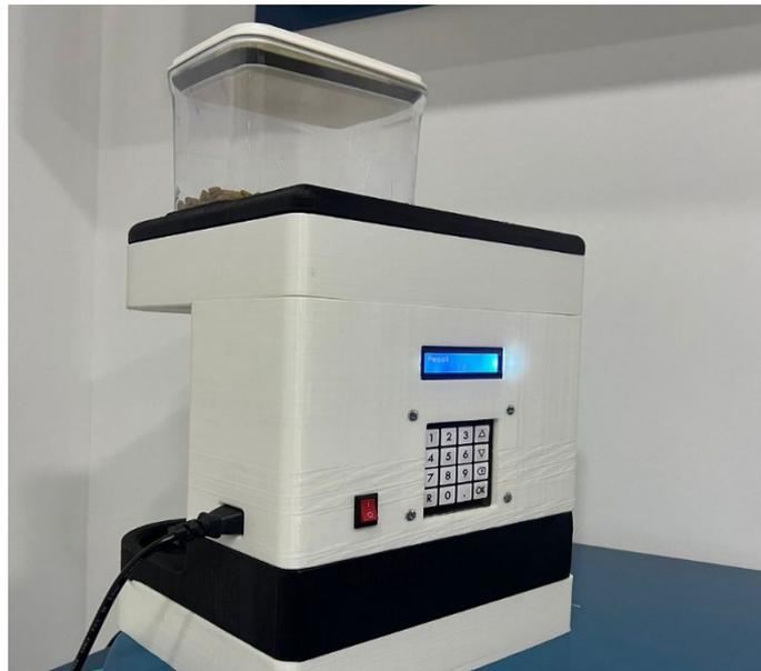
Fig. 21. Máquina Dosificadora de comida y agua
