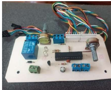
Fig. 38. Placa PCB del sistema de control con sus componentes.
