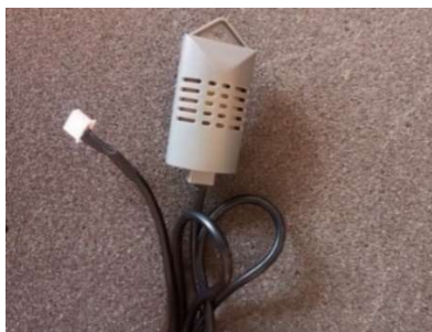
Fig. 25. Sensor de temperatura y humedad.
