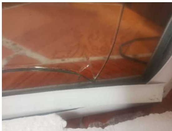
Fig. 45. Ruptura en el vidrio de la máquina.
