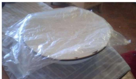
Fig. 10. Humectación por cobertor [1].
