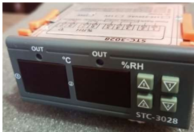
Fig. 24. Controlador digital STC-3028
