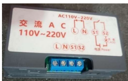
Fig. 27. Entradas y diagrama de conexiones temporizador T3230.
