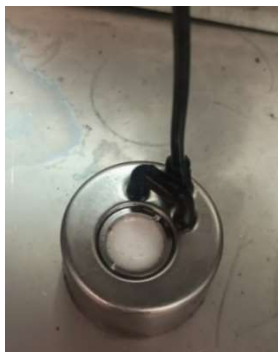
Fig. 41. Nuevo generador de neblina ultrasónico.
