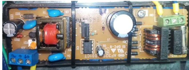
Fig. 36. Fuente convertora de voltaje y corriente.
