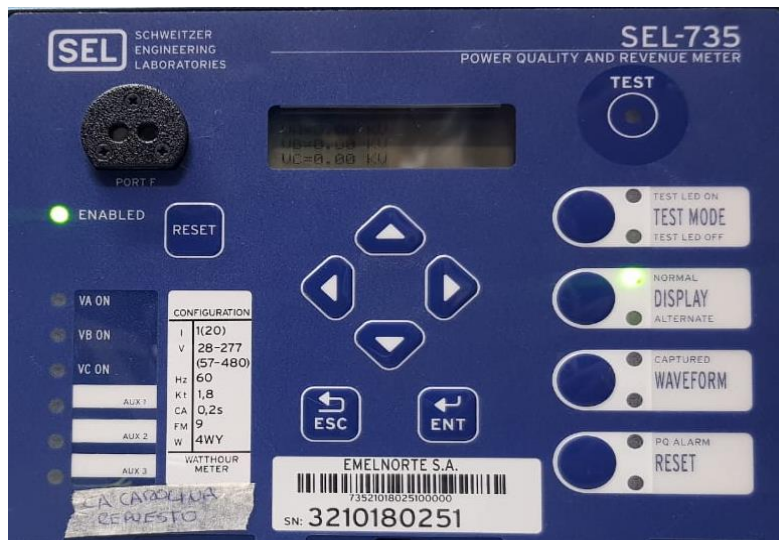
Figura 12. Medidor de energía SEL-735.
