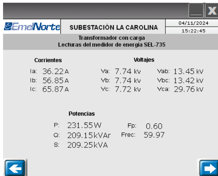
Figura 71. Subpantalla de monitoreo para el transformador de potencia.
