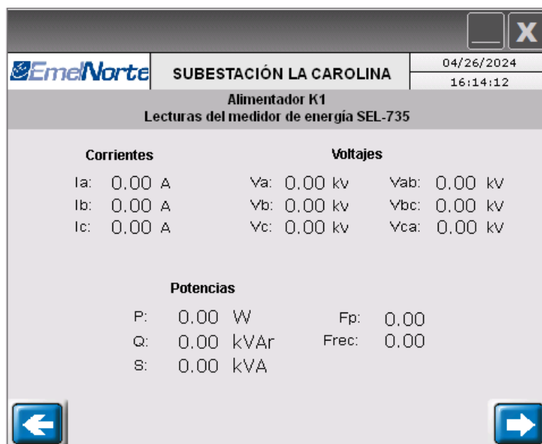
Figura 19. Subpantalla de monitoreo para alimentadores en simulación offline.
