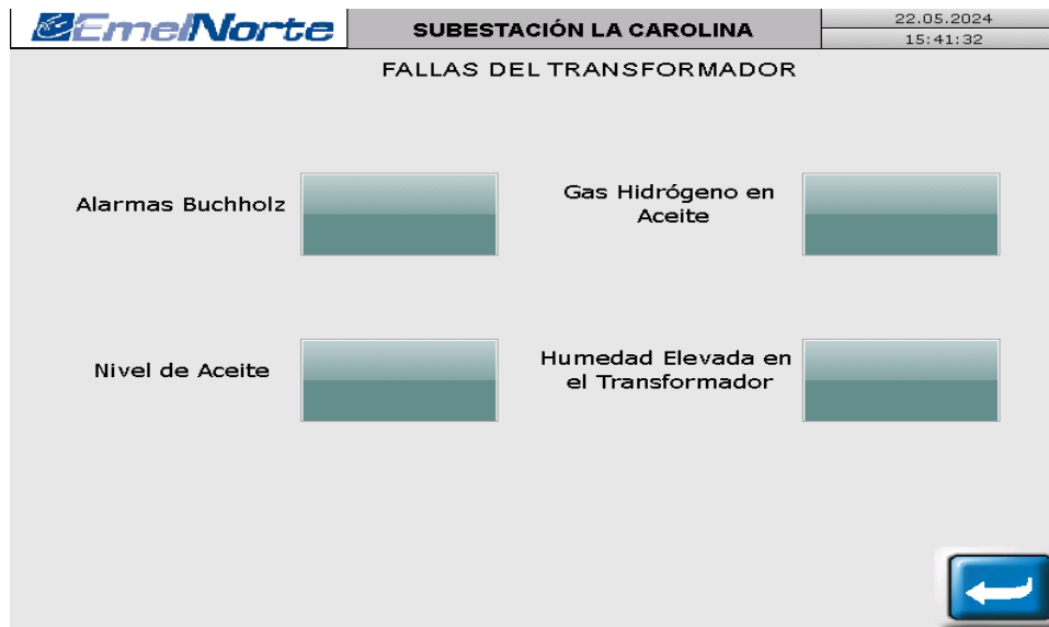
Figura 27. Pantalla de alarmas dedicadas a las señales obtenidas del transformador.
