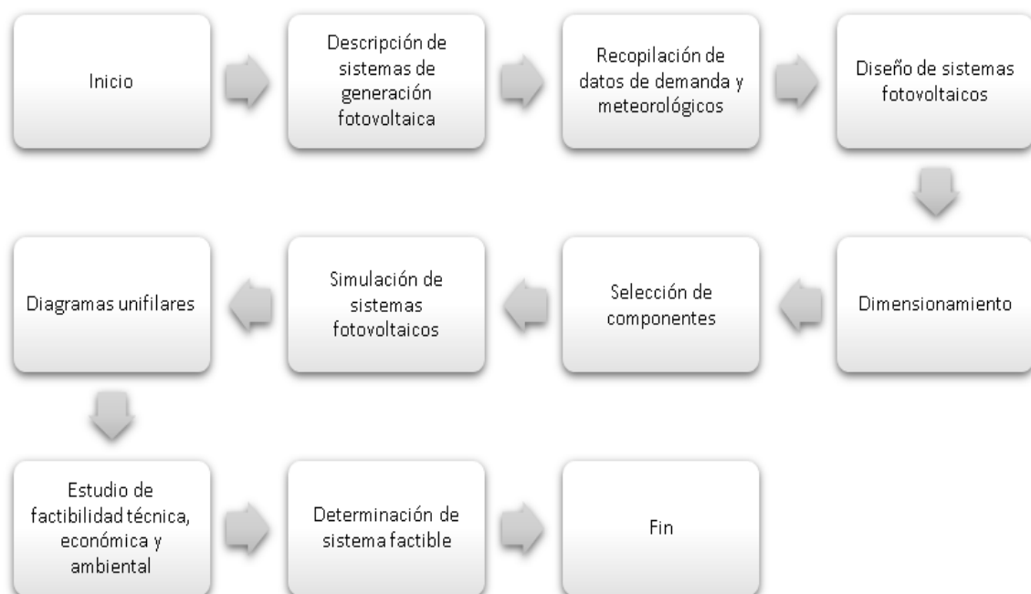
Fig. 9. Procedimiento general para diseño de sistemas fotovoltaicos.
