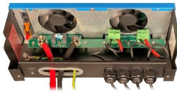
Interior del MPPT RS SmartSolar 450|100
