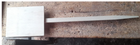
Figura 4.2: Modelo de estaca para colocación de dispositivos.
