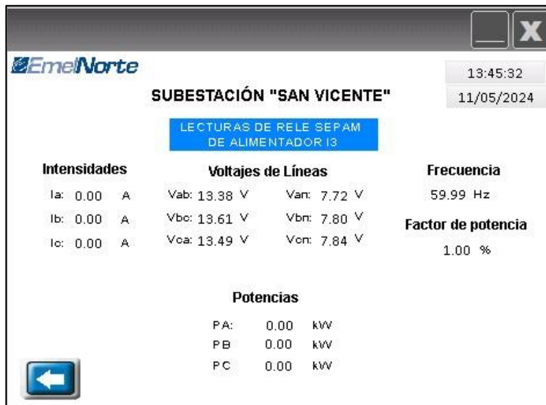
Figura 36. Sub-pantalla con valores en cero por maniobra de ABIERTO en Alimentador I3.
