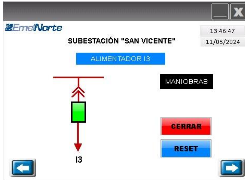
Figura 35. Reflejo de accionamiento de botonera de estado cerrado a estado abierto de Alimentador I3.
