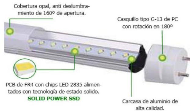
Figura 4 Diagrama de Tubo LED [10]
