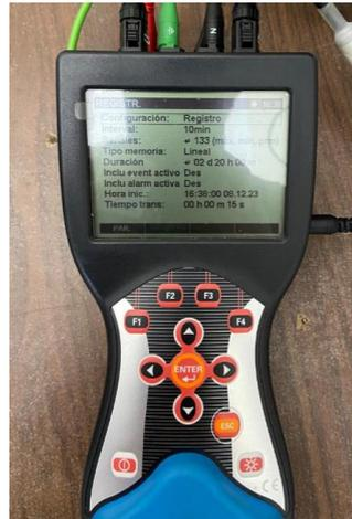
Figura 17: Analizador de redes MetrelQ4 PLUS
