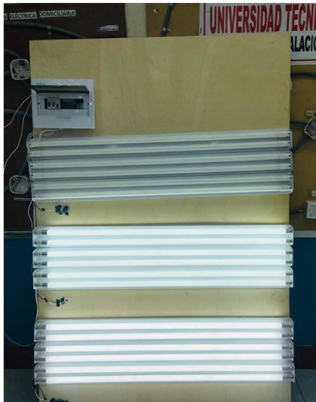
Figura 25 Tablero Experimental de iluminación
