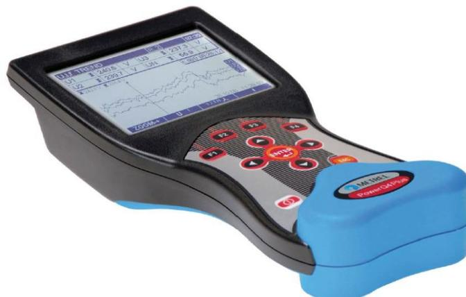
Fig. 3 Analizador de red Metrel Power Q4 Plus. [33]
