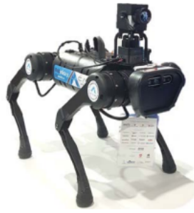
Figura 1.17: Robot ARTU-R equipado con cámara infrarroja [35]
