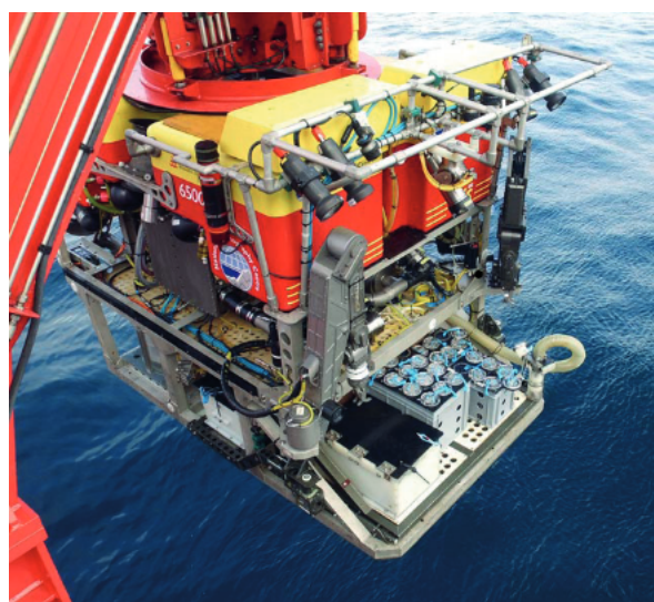
Figura 1.8: ROV 'ISIS', capaz de sumergirse hasta más de 5Km [22]
