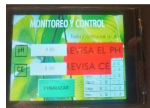
Fig. 3. Lectura y generación de alarma.
