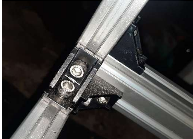
Fig. 14. Ensamblaje de perfiles de aluminio
