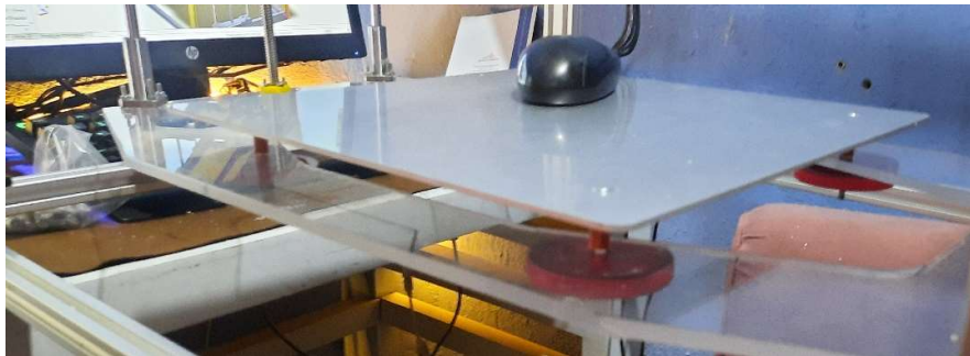
Fig. 17. Instalación de base de soporte cama caliente
