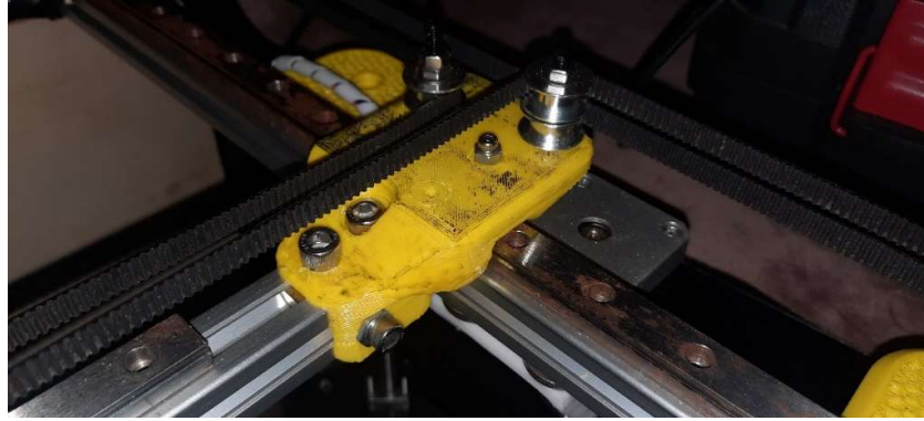
Fig. 18. Montaje de sistema de movimiento
