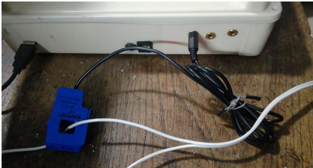
Nota. Ubicación de la pinza amperimétrica en puerto de sensor 3 en la fase del equipo a medir.
