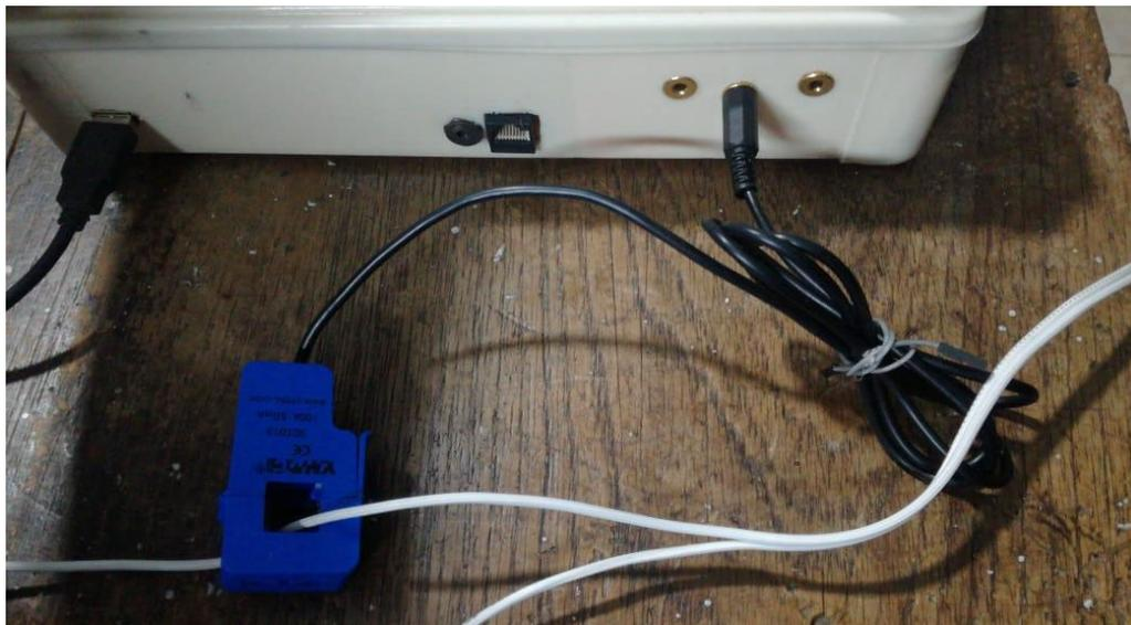
Nota. Ubicación de la pinza amperimétrica en puerto de sensor 2 en la fase del equipo a medir.
