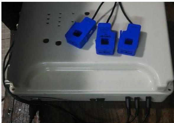
Nota. Sensores de corriente conectados a los Jacks analógicos. Fuente: El autor.
