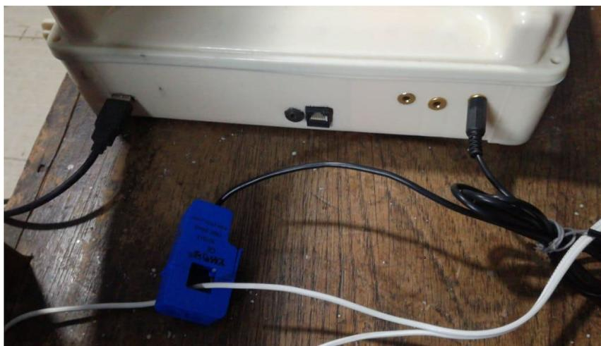
Nota. Ubicación de la pinza amperimétrica en puerto de sensor 1 en la fase del equipo a medir.
