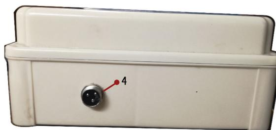
Nota. Puerto de salida del sistema para la supervisión de la operación de maquinaria industrial mediante la autenticación con tecnología RFID. *Fuente: El autor.*
