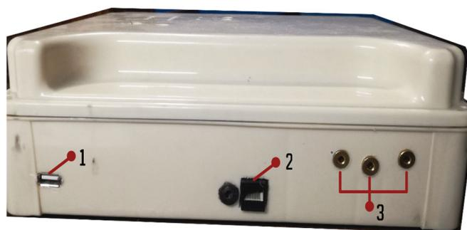
Nota. Puertos de entrada del sistema para la supervisión de la operación de maquinaria industrial mediante la autenticación con tecnología RFID. *Fuente: El autor.*
