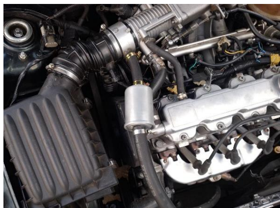
Filtro de GLP.
