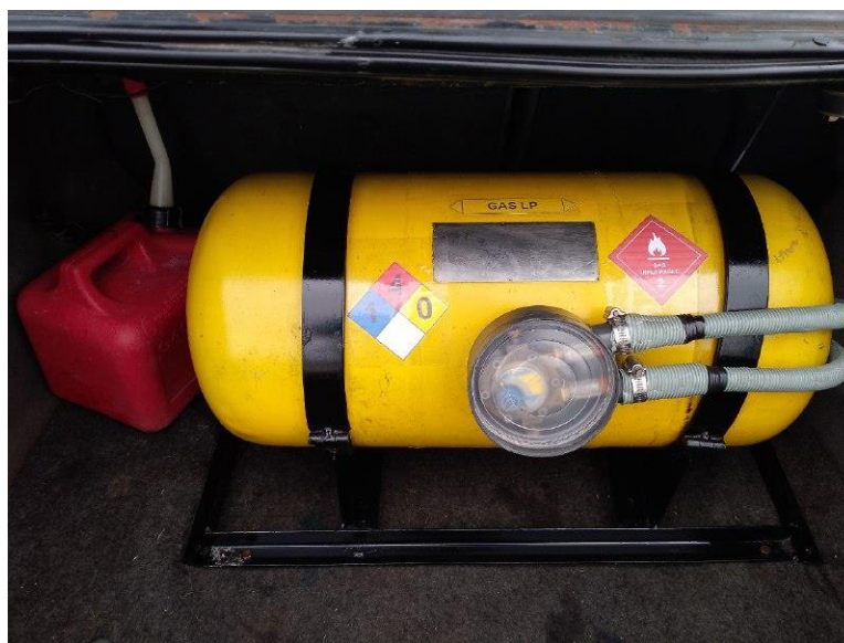
Anexo 3. Ubicación del cilindro de GLP en el compartimiento del MEP.
