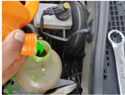
**Prueba con agua:** Para la prueba con agua se decidió realizarla retirando el termostato para evidenciar las consecuencias de esta práctica que se tiene regularmente, en la **Figura 19** se puede visualizar la colocación del agua para realizar la prueba.
