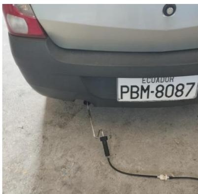
En la NTE INEN 2203:2013 nos muestra el procedimiento que se debe llevar a cabo para realizar las pruebas y en la NTE INEN 2204:2017 nos muestra los límites en los cuales nos basaremos para llevar a cabo las pruebas, además en la **tabla 5** se indica los límites permitidos para emisiones según la normativa NTE INEN 2204:2017.
