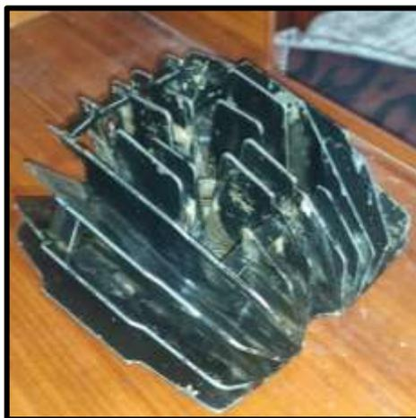
**Figura 1. 6** Culata de motor dos tiempos refrigerada por aire
