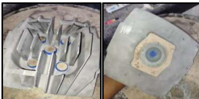
**Figura 2. 24** Preparación de la matriz para obtener el molde
