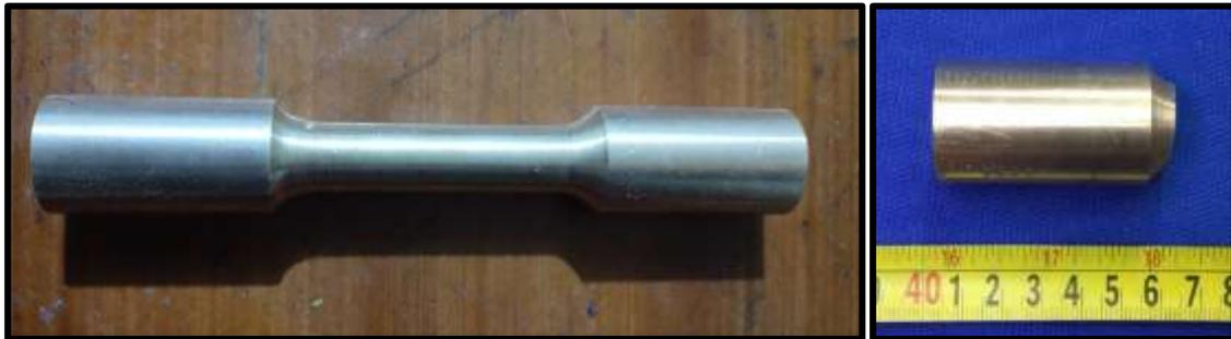
**Figura 3. 10** Probeta de bronce antes y después del ensayo a tracción
