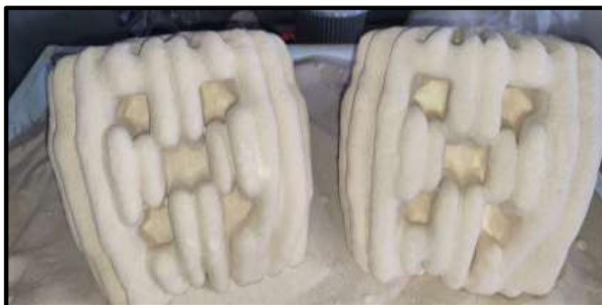
**Figura 2. 30** Molduras con arena sílice terminadas
