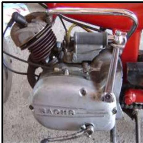
**Figura 1. 3** Motor de dos tiempos refrigerado por aire
