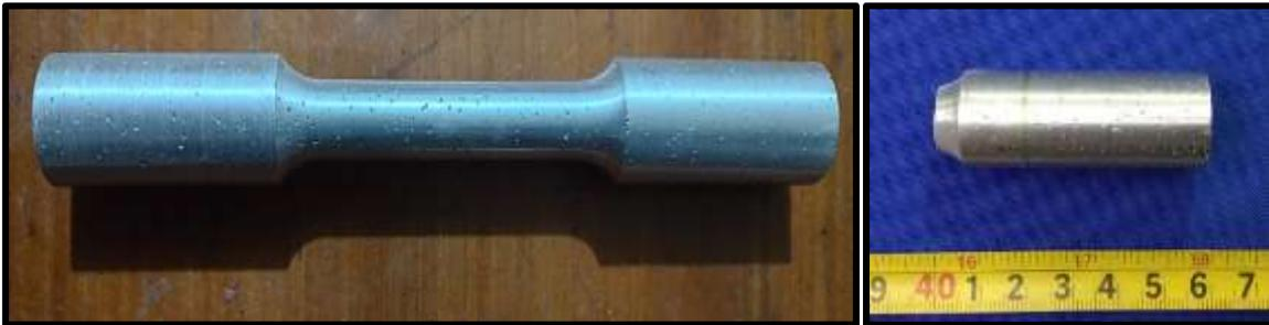
**Figura 3. 8** Probeta de aluminio antes y después del ensayo de tracción
