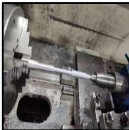
**Figura 2. 10** Torneado de la probeta de aluminio
