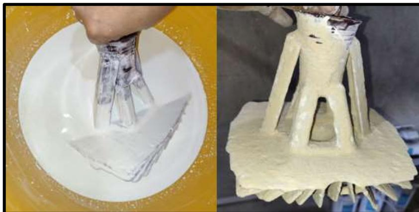
**Figura 2. 29** Proceso de inmersión en barbotina con cubierta de arena sílice
