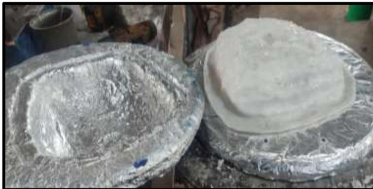
**Figura 2. 25** Proceso de moldura para la obtención del negativo
