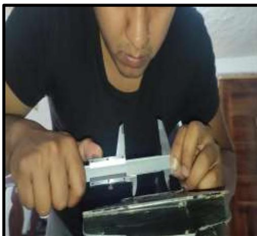
**Figura 2.3** Uso del vernier para la toma de medidas
