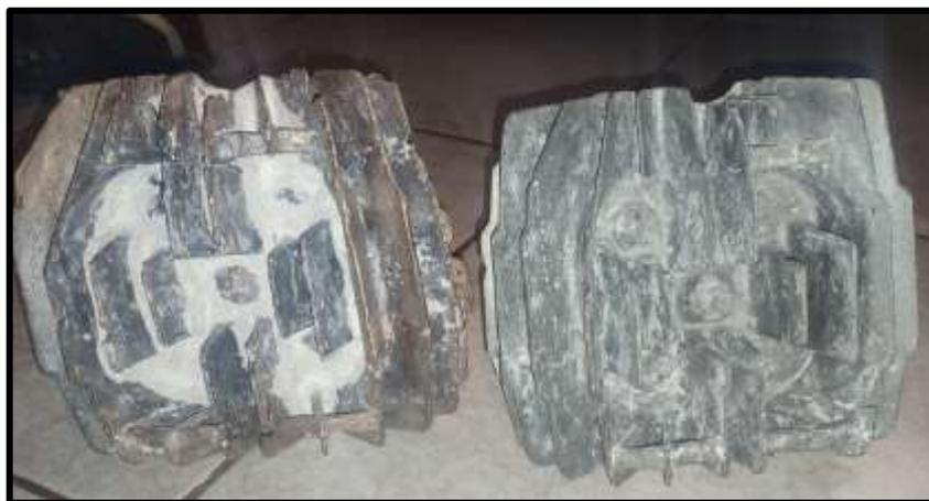
**Figura 2. 33** Obtención de prototipos de bronce y aluminio mediante molde de cascarilla
