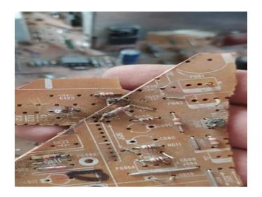
La baquelita es un compuesto de fenol y fenoplástico, desde sus inicios se aprovecharon sus propiedades únicas en comparación con otros plásticos. Appold et al. (2005) explican que un fenoplástico se produce mezclando fenol con formaldehído, resultando un material muy rígido. Este compuesto se conoce como alquitrán de hulla y su fórmula química es (C<sub>6</sub>H<sub>5</sub>OH) para el fenol y (HCHO) para el formaldehído.
