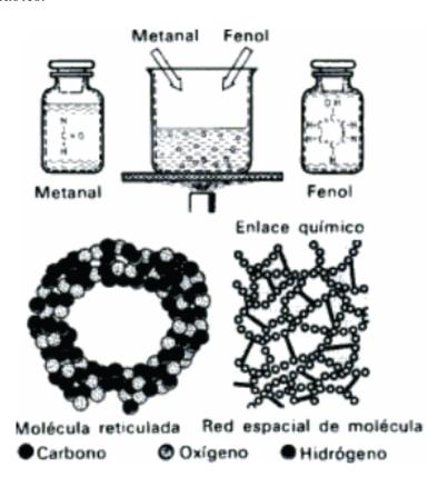
**Nota:** Las moléculas de fenol y metanal se combinan para formar baquelita. Estos compuestos se unen químicamente, creando macromoléculas reticuladas. **Fuente:** (Appold et al. 2005).
