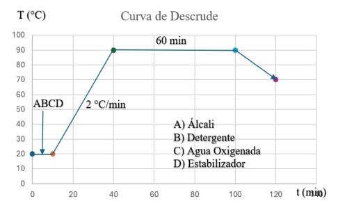
**Nota:** Etapas del proceso de descrude: preparación del material, tratamiento alcalino, lavado, blanqueo, enjagüe y neutralizado. En la Tabla 10, se visualiza la hoja de consumo.
