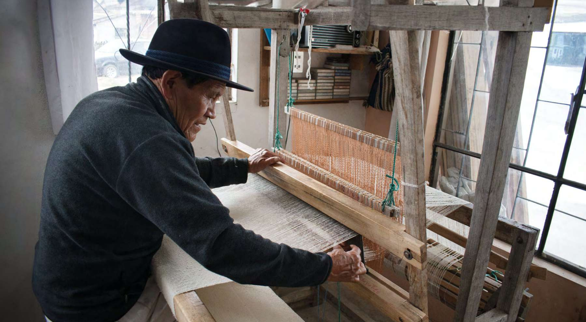
Pedro cruzando la lanzadera en el telar - Pedro crossing the weaving shuttle in the treadle loom
