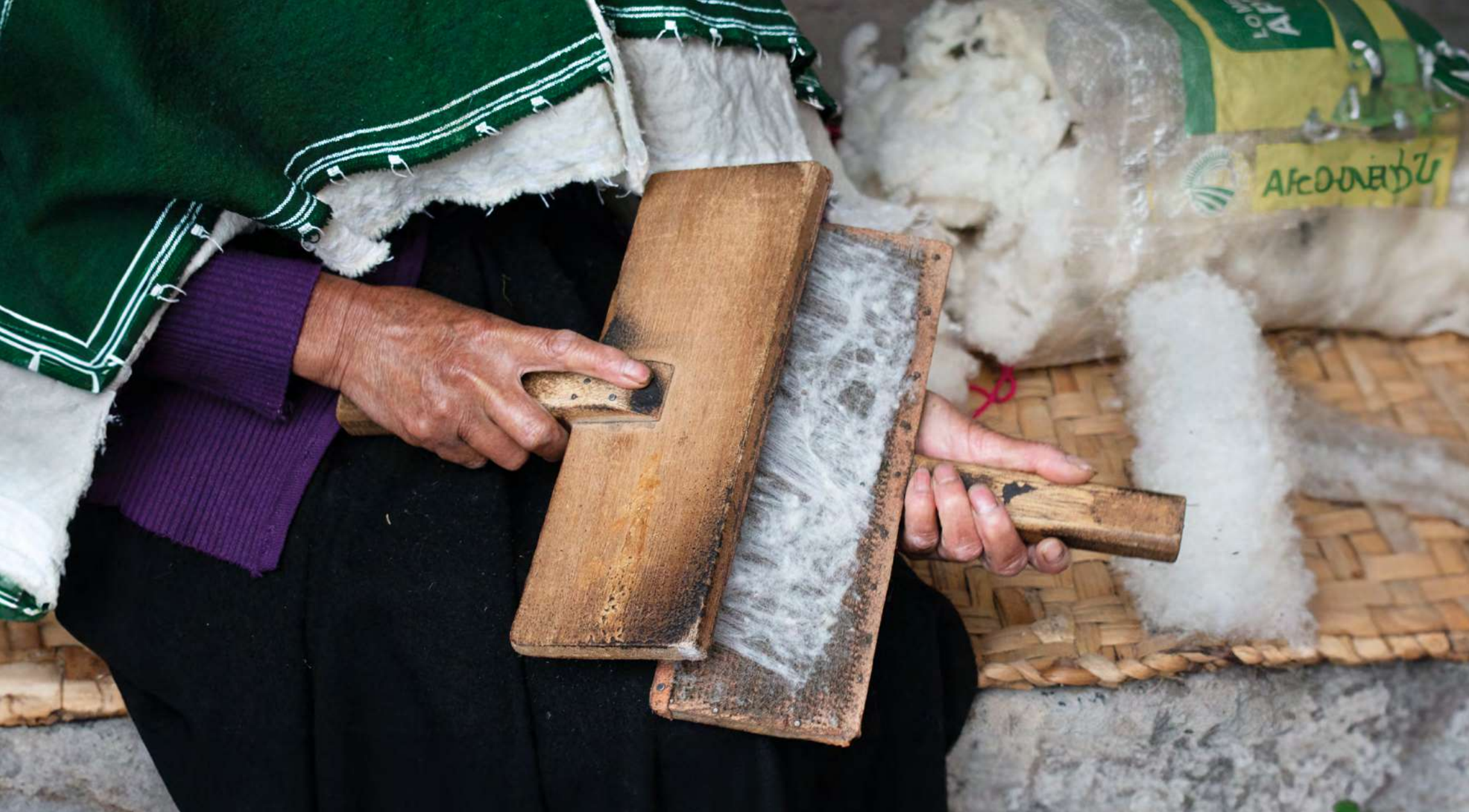
Carda o tizadora de lana - Wool carder or wool teaser
