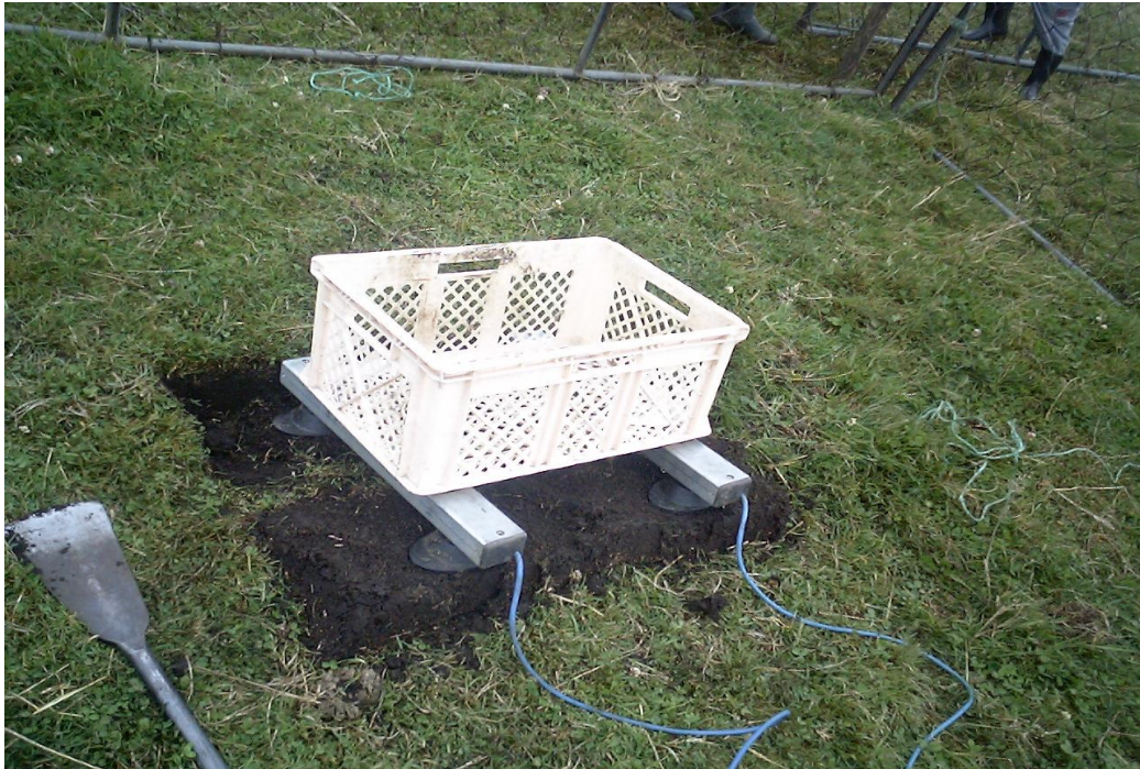
Foto # 3. Instalación de Bascula electrónica.
