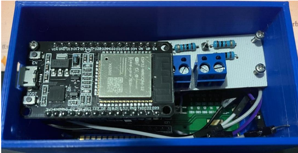
Fig. 4.17 Ensamblaje del dispositivo de medición de dióxido de carbono, vista interior.
