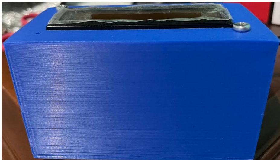
Fig. 4.18 Ensamblaje del dispositivo de medición de dióxido de carbono, vista exterior.
