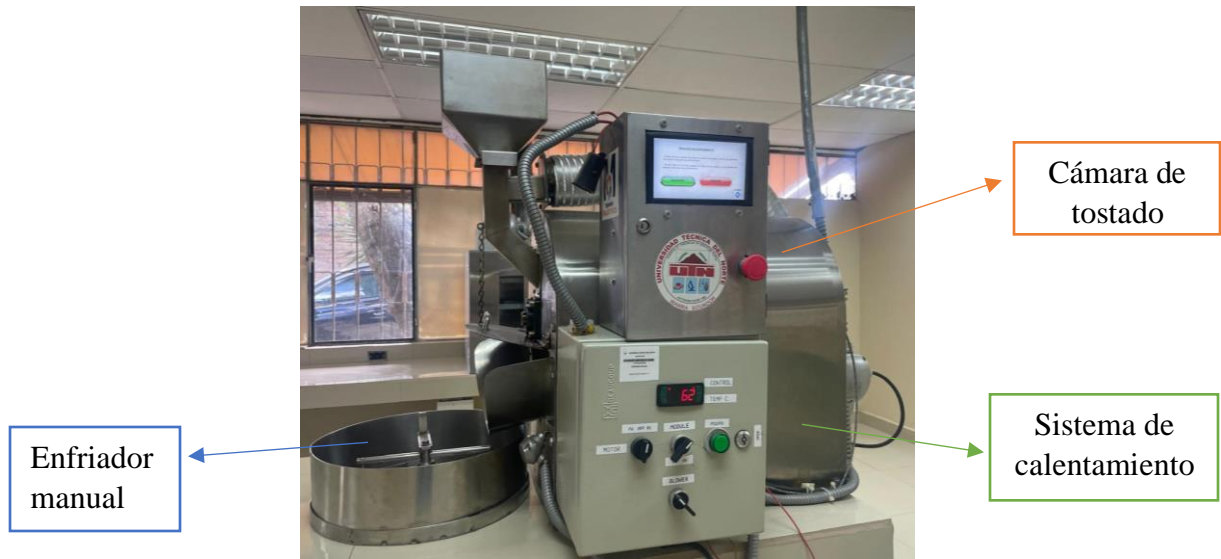
Fig. 2.6 Partes de una tostadora de café eléctrica.
