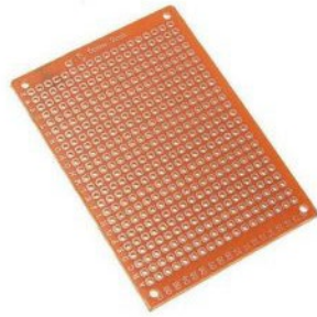
Figura 4.22. Placa perforada 120x100 [mm].
