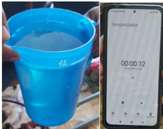
Figura 4.40. Verificación exitosa del caudal.
