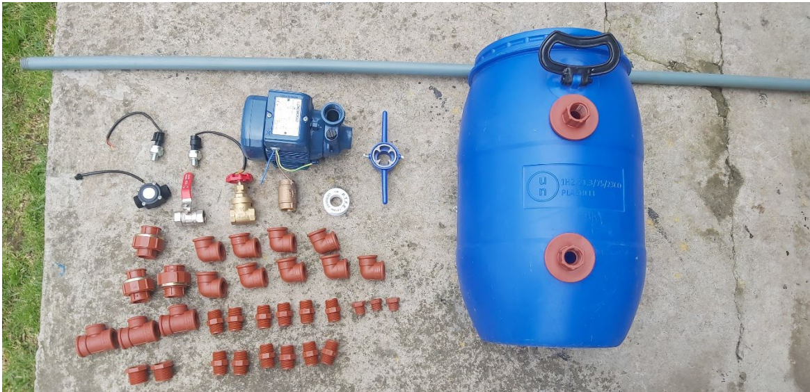
Figura 4.33. Componentes del sistema del banco de ensayos de válvulas y accesorios.
