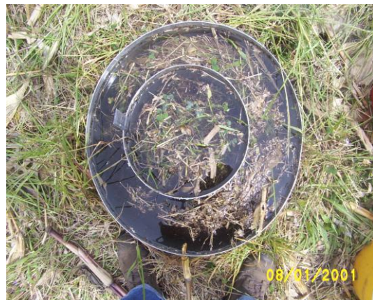
Fotografía 15. Prueba de infiltración
