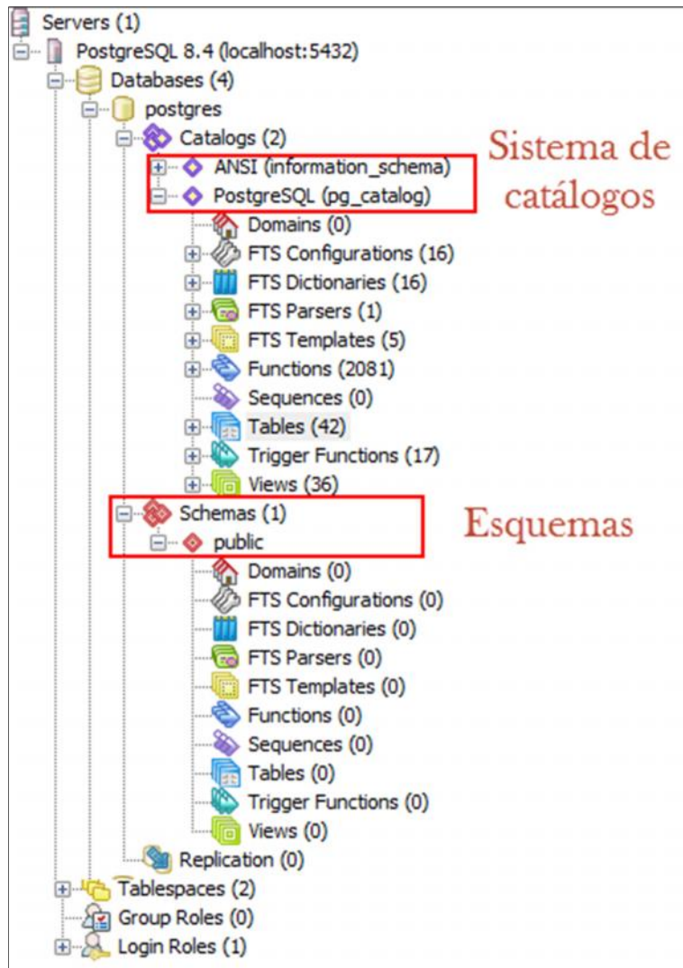
Figura 25: Organización de los sistemas de catálogos de postgres Fuente: Propia
