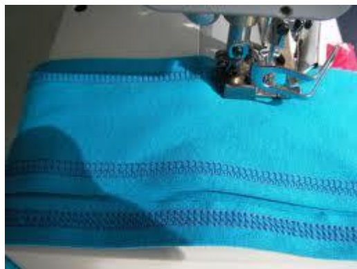
Gráfico N° 35 Puntada correcta de Maquina industrial Recubridora
