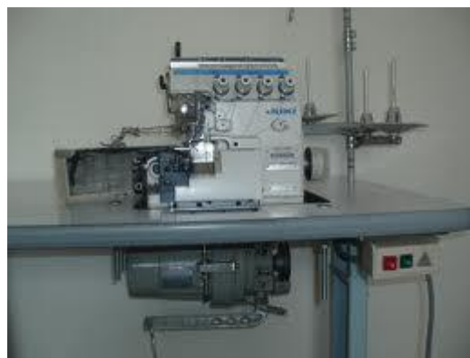
Gráfico N° 31 Tapa abierta de overlock para calibrar largo de puntada
