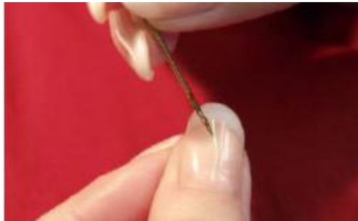
Gráfico N° 23 Método de control de la punta de la aguja
