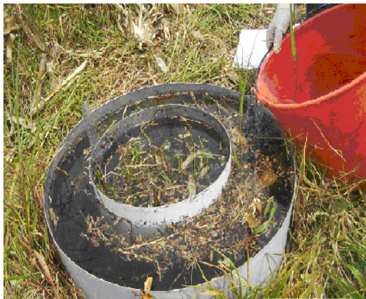
Fotografía 12. Prueba de Infiltración con los cilindros
