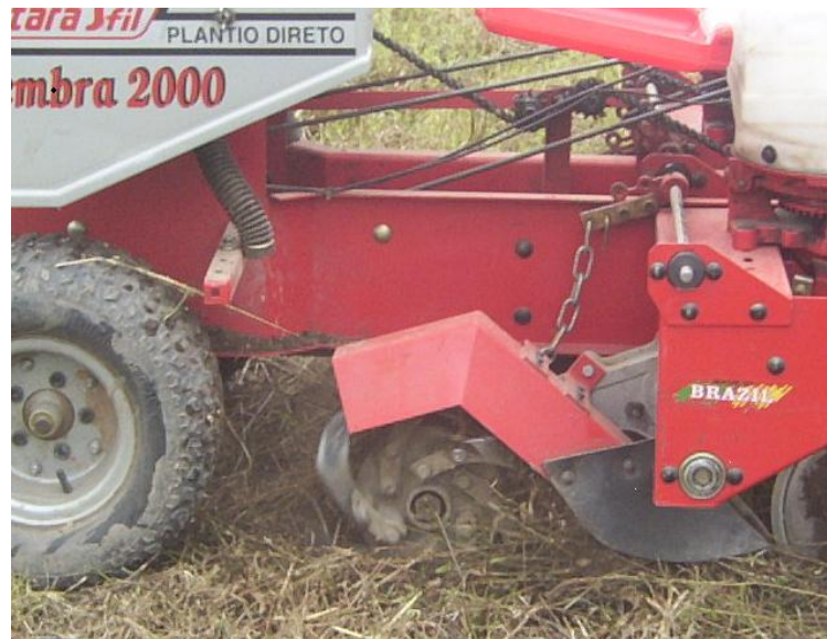
Fotografía 1. Maquinaria de siembra directa utilizada en el ensayo.
