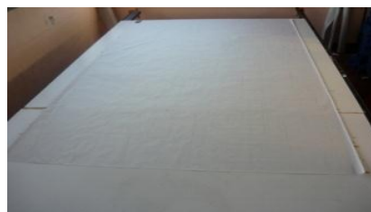
Gráfico 60: Trazo digital impreso sobre la mesa de tendido.
