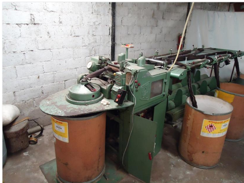
Fig. 69 Gill para 1er Paso utilizado para mezclas
