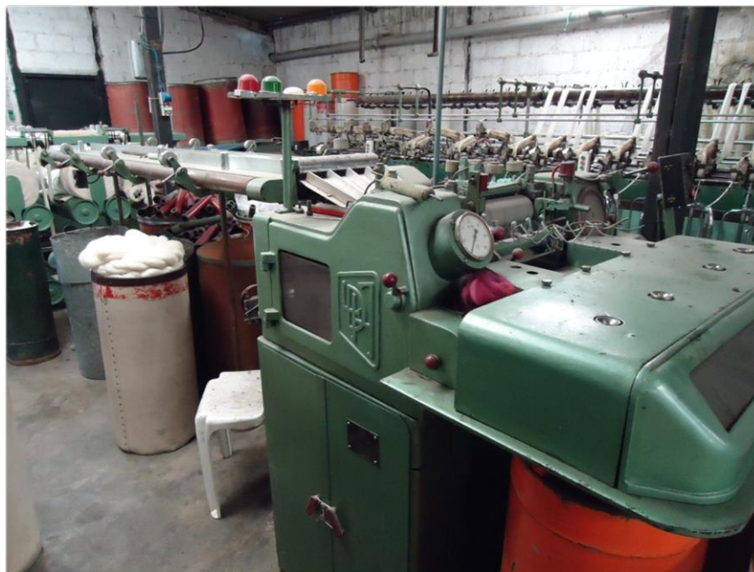
Fig. 70 Gill para 2do Paso utilizado para acrílico y sus mezclas
