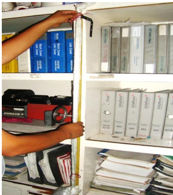
Figura # 11 Fotografía del método de medición de una mecha termo seccionada para realizar una prueba de encogimiento.
