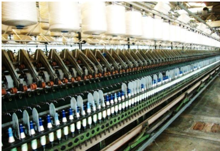
Figura # 9 Fotografía de una continua de hilar de fibra larga marca Zinser
