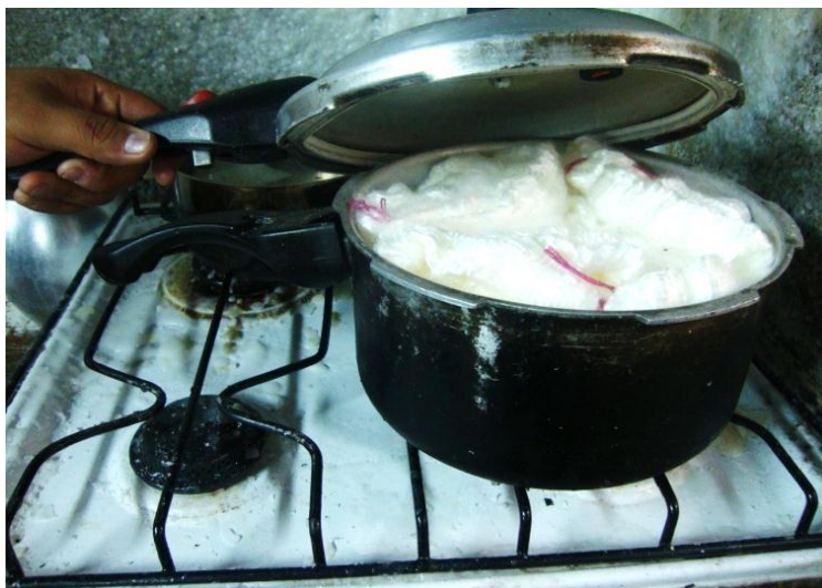
Figura # 12 Fotografía de una olla de presión que contiene mechas termo seccionadas al momento de realizar una prueba de encogimiento.
