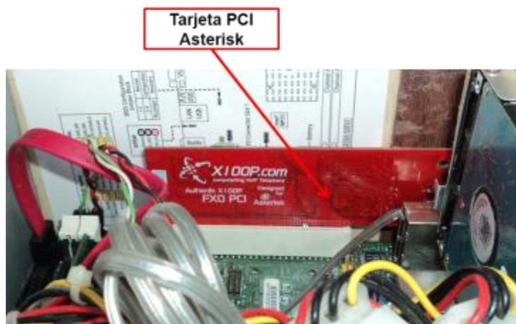
Figura 44. Tarjeta Asterisk X100P con 1 puerto FXO, para una línea telefónica.
