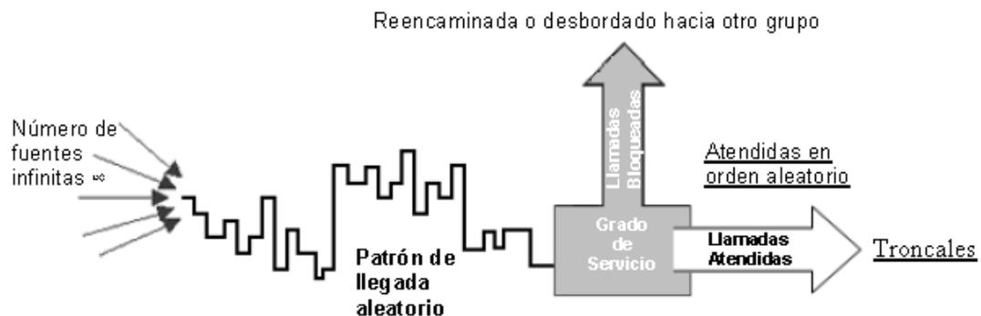
Figura 25. Modelo de tráfico Erlang B (3CX, 2010).
