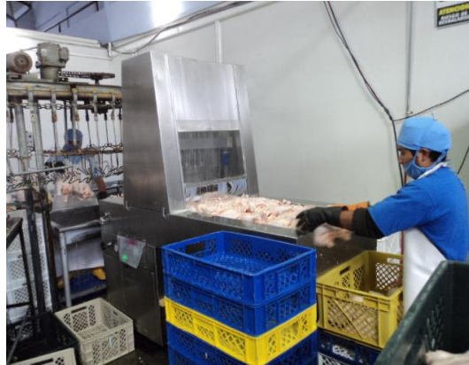
FOTOGRAFÍA 14. Colocación de las canales en la máquina inyectora, Noviembre 2009
