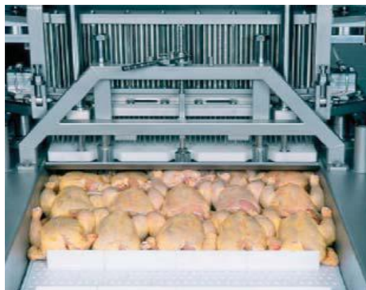
FOTOGRAFÍA 15. Adición de salmuera por el método de inyección, Noviembre 2009
