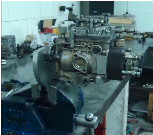
Figura 67. Montaje de la bomba en la prensa
