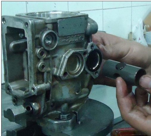
Figura 74. Desmontaje del cilindro del variador de avance
