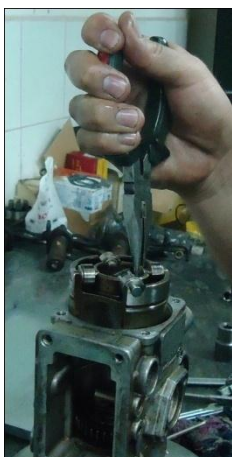
Figura 75. Desmontaje del conjunto de rodillos
