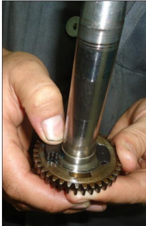
Figura 85. Montaje de los cauchos en el eje del rotor
