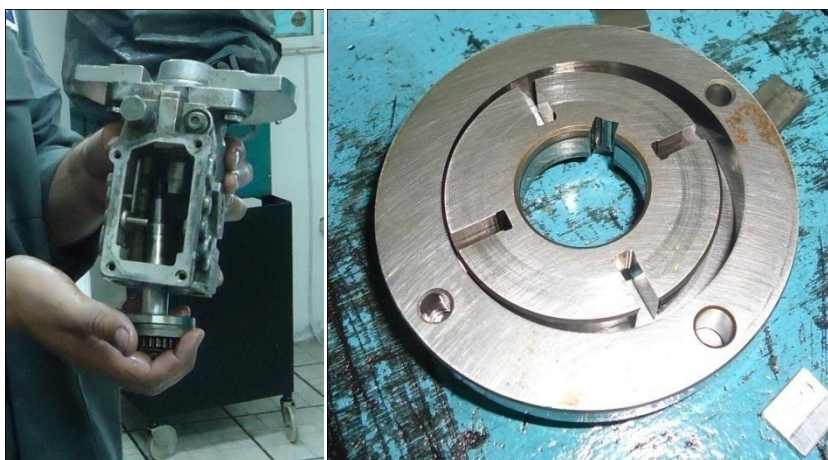
Figura 77. Desmontaje de la boba de alimentación
