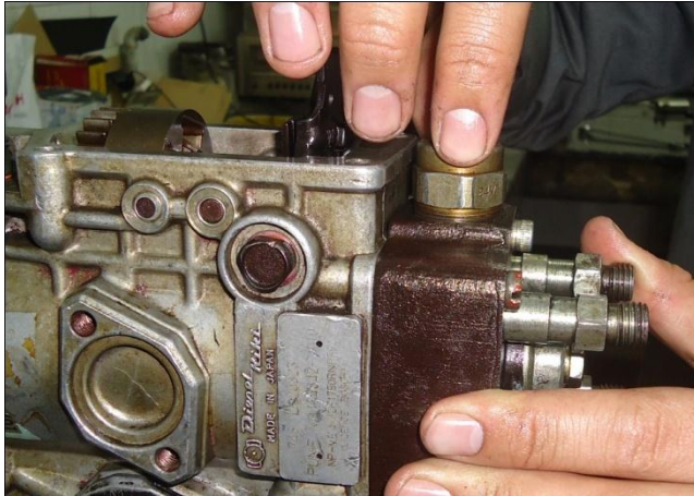
Figura 95. Montaje del solenoide
