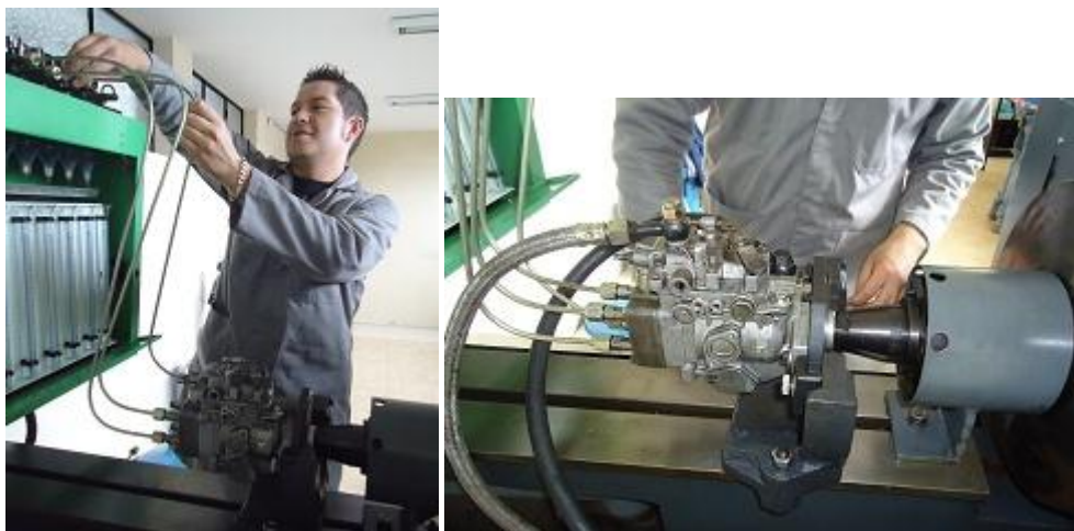
Figura 100. Instalación de cañerías a los inyectores y colocación de cañerías de entrada y retorno de combustible.
