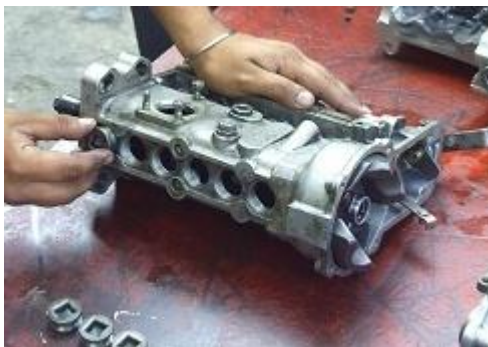
Figura 108. Desmontaje de las tuercas inferiores.
