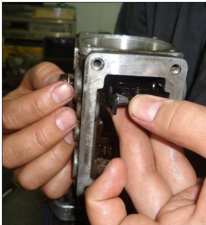
Figura 90. Montaje de la palanca del gobernador
