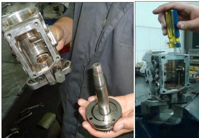
Figura 84. Montaje de la bomba de alimentación
