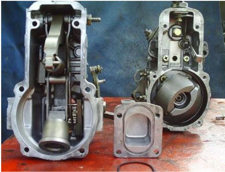
Figura 104. Desarmado del regulador para cambiar el empaque
