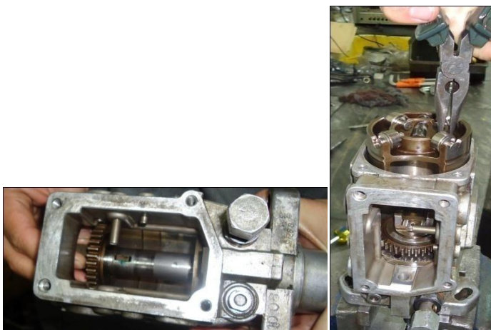
Figura 86. Montaje del conjunto de rodillos
