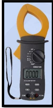
Figura 24 Pinza amperimétrica Fuente: Instrumento GPI
