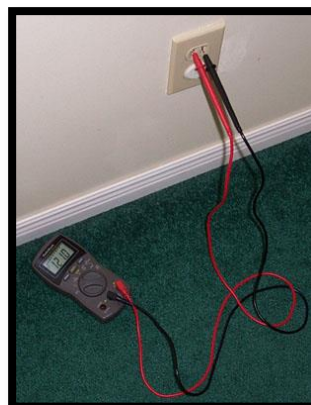
Figura 23 Conexión del multímetro para medir voltaje Fuente: GPI
