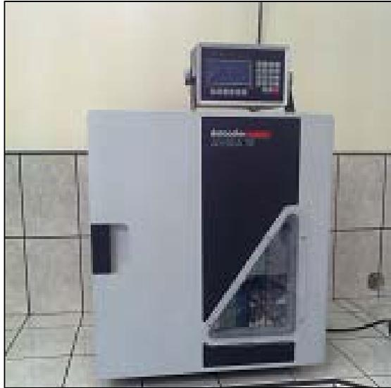
**Foto N°3. Equipo de tintura AHIBA IR**
