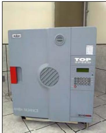
Foto N°1. Máquina de Tintura AHIBA NUANCE Top Speed.
