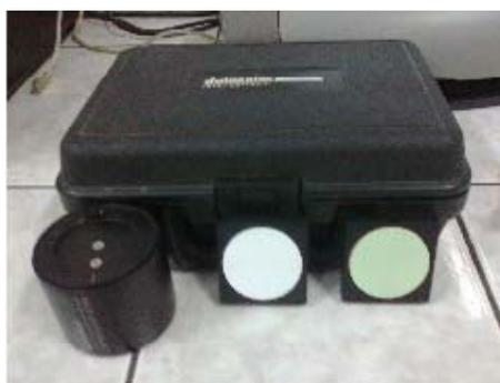
**Foto N°7. Accesorios para calibrar el espectrofotómetro.**
