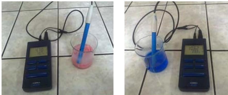
Foto N°11. Izq. Medición pH ácido, Der. Medición pH alcalino)
