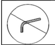
No utilizar una llave hexagonal en lugar del destornillador hexagonal. Si no la tapa podría quedar muy apretada.
