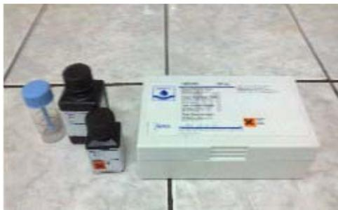
Foto N°10. Medidores de dureza del agua
