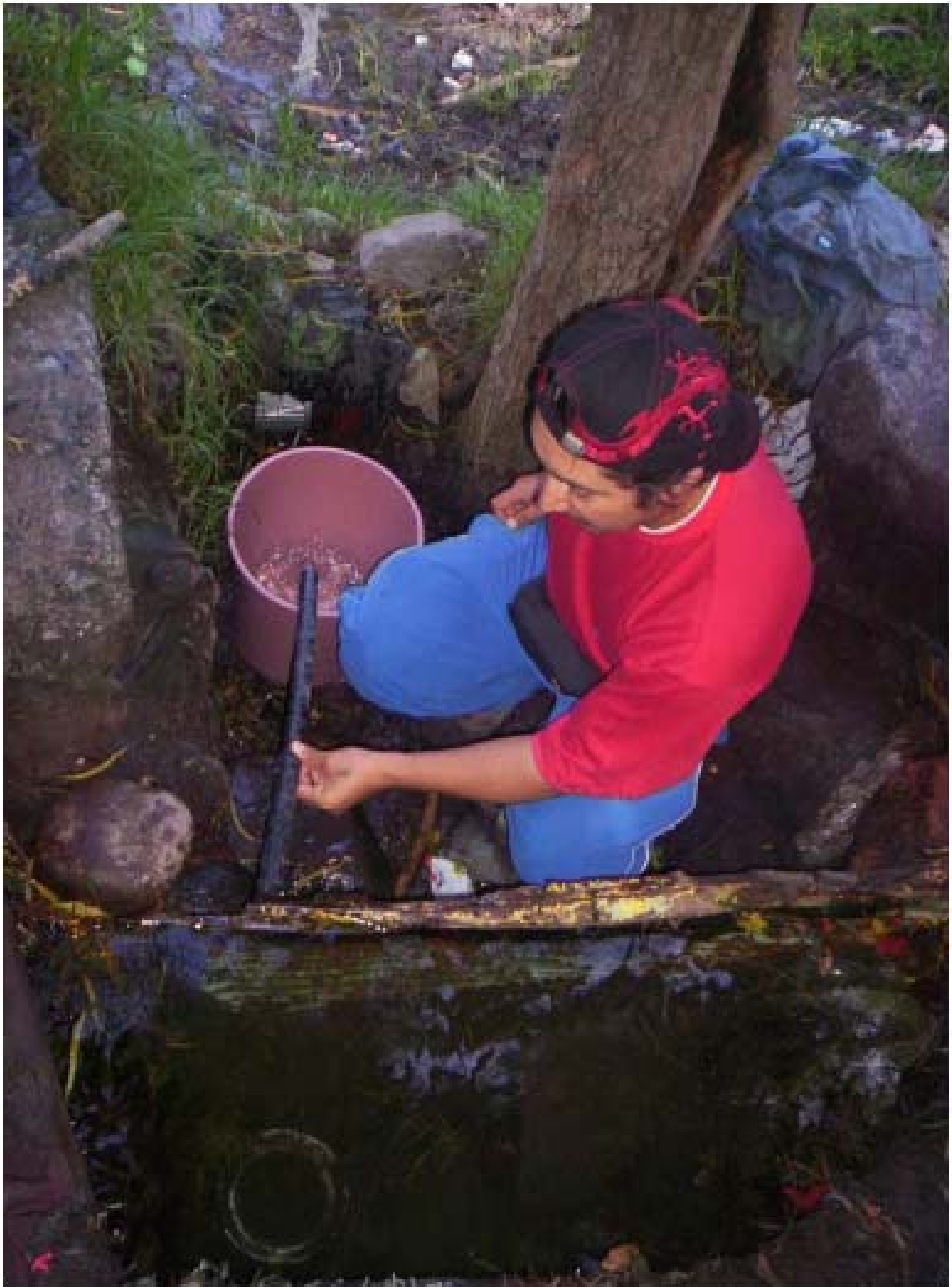
Fotografía 2. Aforos realizados en los manantiales.
