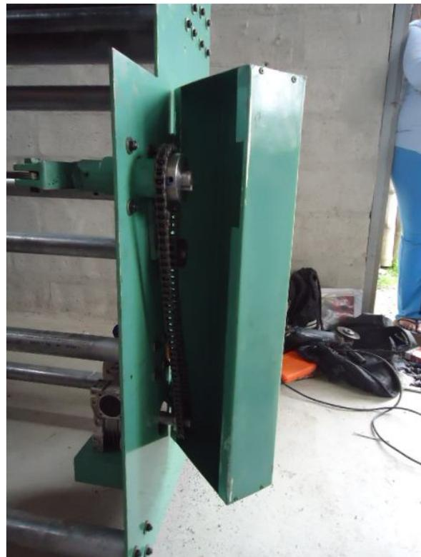
**Fig.44 Sistema de Movimiento cubierto con una tapa de latón.**
