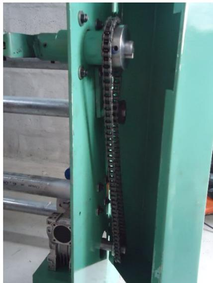
**Fig. 49 Transmisión por cadena.**
