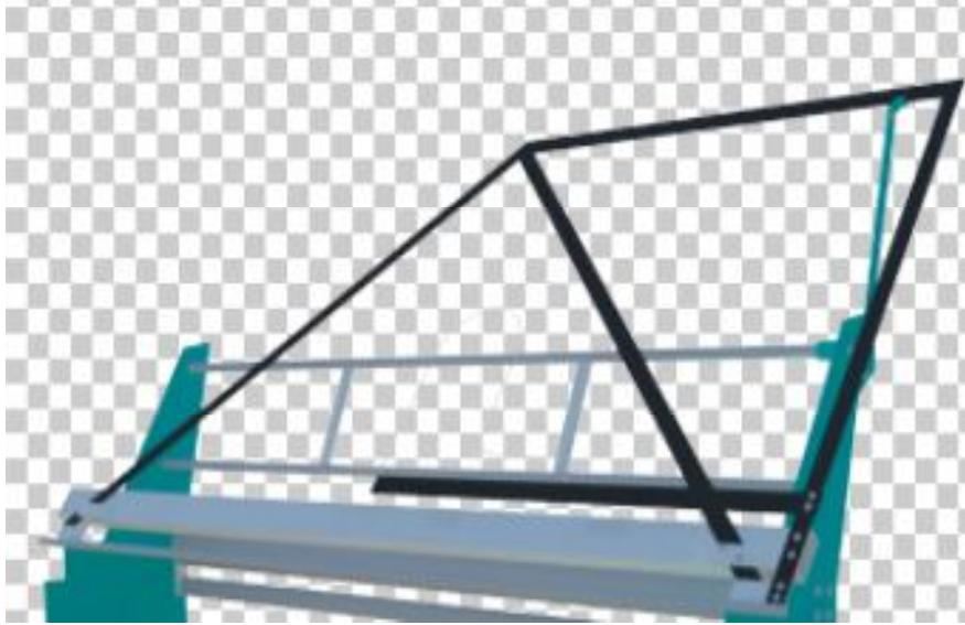
**Fig.35: Sistema Doblador un triángulo donde se produce el doblado de la tela.**
