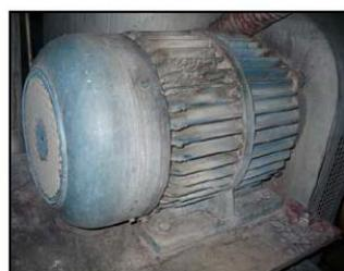
Fig. 31 Motor eléctrico
