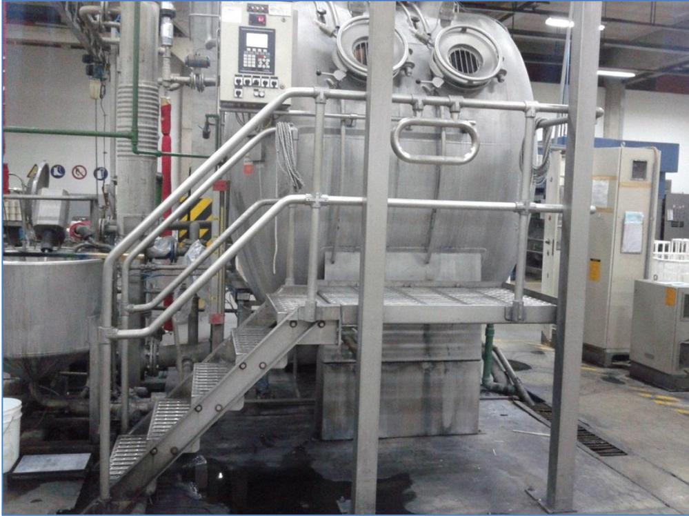
Fig. 6 Cuerpo o cámara de proceso
