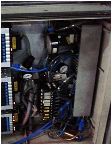
Fig. 18 Unidad de tratamiento de aire comprimido
