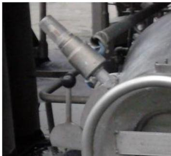
Fig. 14 Válvula de seguridad y
