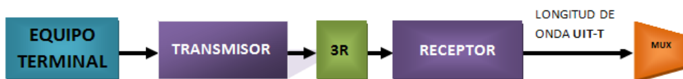
Figura 5. Función de un transponder. Adaptado Conceptos Básicos de DWDM (2011). Recuperado de: www.ucursos.cl/ingenieria/2008/1/EL65A/1/material_docente/previsualizar?id_material=164151
