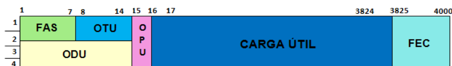
Figura 14. Estructura de Trama OTN. Adaptado de Interfaces para Redes de Transporte Óptico (Febrero, 2012). Recuperado de: http://www.itu.int/rec/T-REC-G.709-201202-1/es
