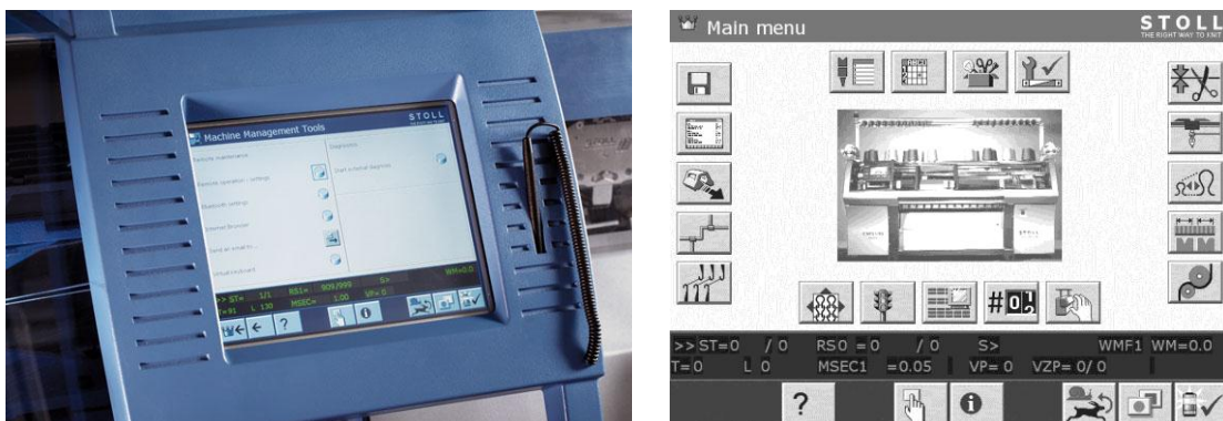
Figura 55: Pantalla táctil que controla la máquina rectilínea.
