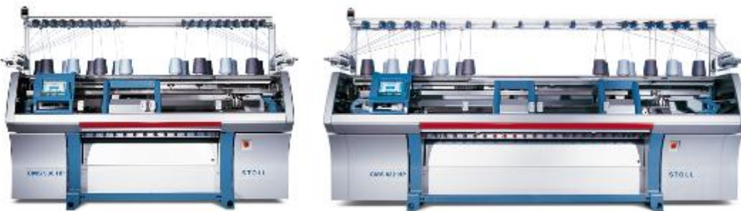
Figura 54: A la izquierda máquina con un solo carro y a la derecha máquina con dos carros y trabajando en tándem (carros separados).
