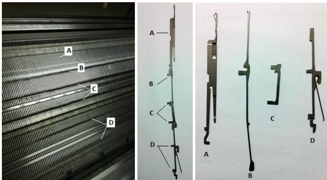
Figura 41: Aguja, pieza de acoplamiento, platina intermedia y selector de una máquina Stoll. A la izquierda colocadas en la fontura y mostrando los talones que sobresalen, en el centro la manera como se ubican las agujas y demás componentes en la fontura y a la derecha cada elemento mostrado individualmente.
