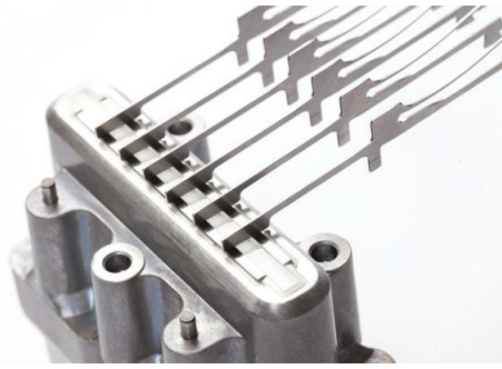
Figura 44: Bloque de selección electromagnético con selectores adheridos en su parte superior.
