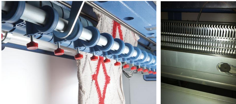
Figura 48: A la izquierda sistema de estiraje de rodillos y a la derecha sistema de estiraje con peine.
