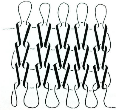
Figura 6: Tejido de punto por trama. El hilo que lo forma tiene su dirección general horizontal.
