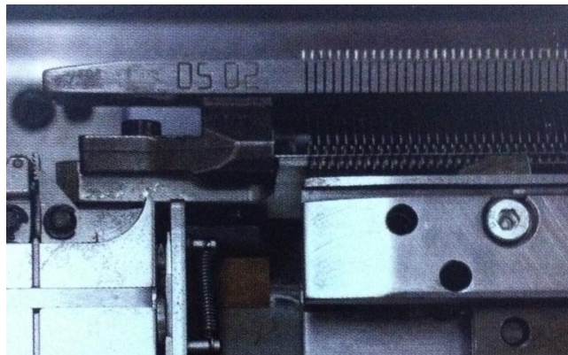
Figura 47: Visualización que muestra el movimiento del variador de la fontura trasera hacia la izquierda con respecto a la fontura delantera.
