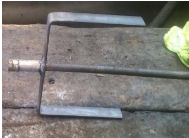
Fig. 141 Construcción de Guía hilos
