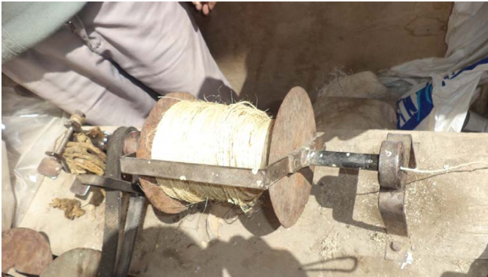
Fig. 135 Funcionamiento de la rueca de cabuya Fuente: Pertenencia del Sr. Humercindo Ipiales
