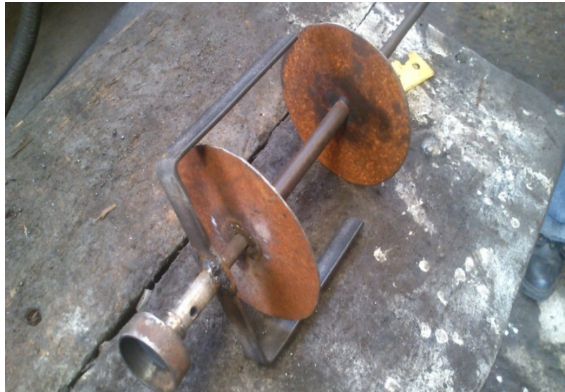
Fig. 143 Colocación del eje principal de Torsión
