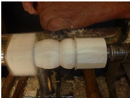
Figura 37. Ensayo de torneado
