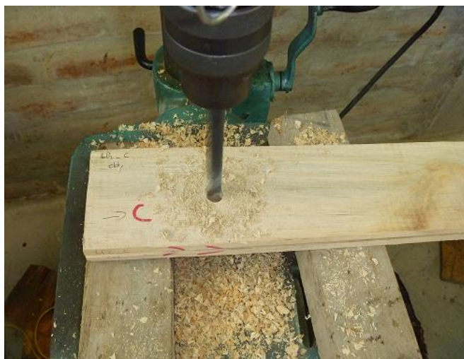
Figura 38. Ensayo de Taladrado
