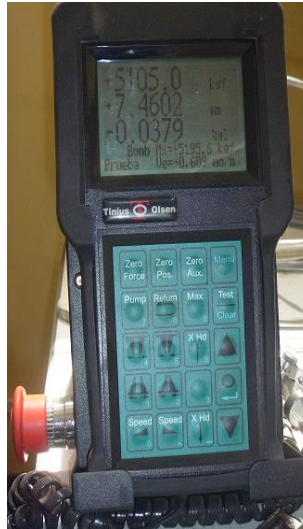
Figura 19. Registrador de la deformación (deflectómetro)
