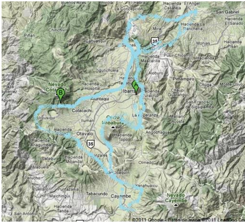
Figura 62. Cobertura de la repetidora Cotacachi
