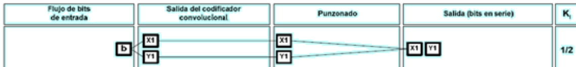
Figura 25. Proceso Codificación-Punzado en k_1=1/2 .
