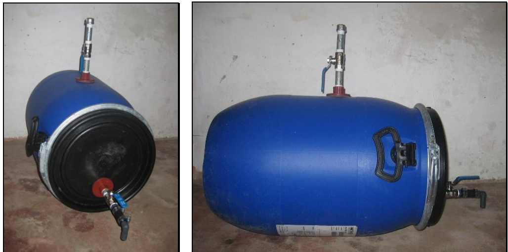
Fotos 4 y 5: Vista de los biodigestores terminados
