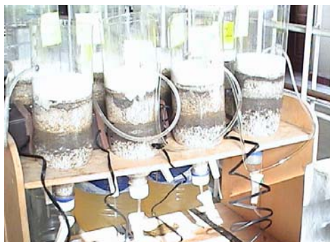
Figura 3.5 Pruebas de pretratamiento en filtros de columna
