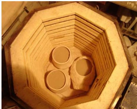
Figura 3.6 Horno eléctrico usado en la activación térmica.
