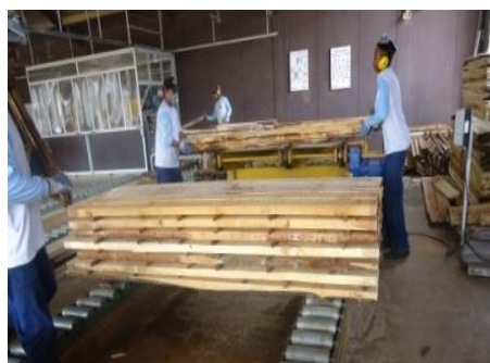
Emparrillado de tablonas aserrados
