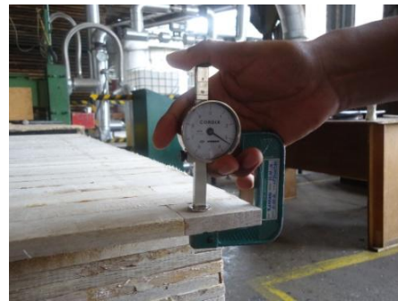
Medición de contenido de humedad del tablón cepillado
