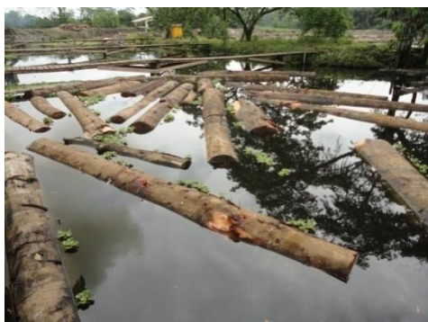
Piscina de ablandamiento de trozas
