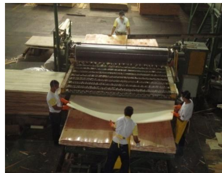
Encolado y armado del tablero
