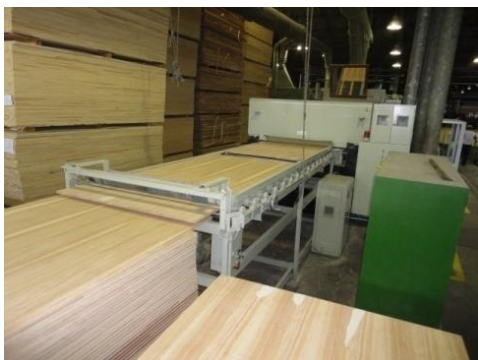
Lijado de tableros
