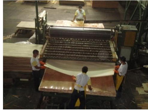
Encoladora de almas y armado de tableros
