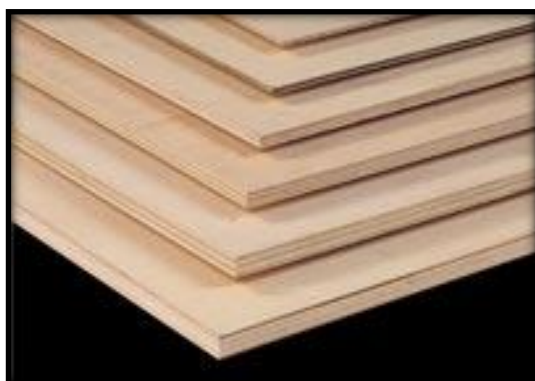
Figura 12. Tablero contrachapado de madera
