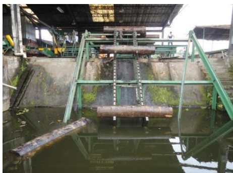
Transporte inclinado de trozas
