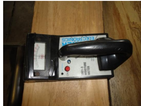
Medición de contenido de humedad del tablón cepillado
