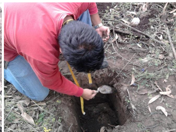
Fotografía 22: Recolección de muestras para determinar propiedades físicas
