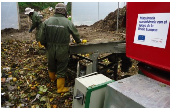
Fotografía 21: Picadora, banda transportadora: picado de residuos.
