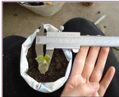
Fig. 3.10. Midiendo el diámetro con el calibrador pie de rey en milímetros y fracciones de milímetro
