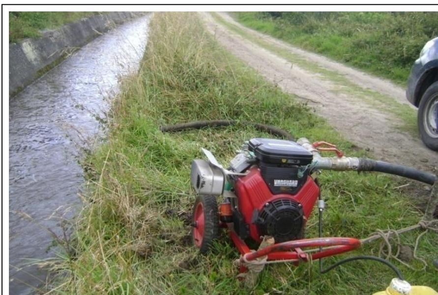
Bomba empleada para captar el agua del canal.
