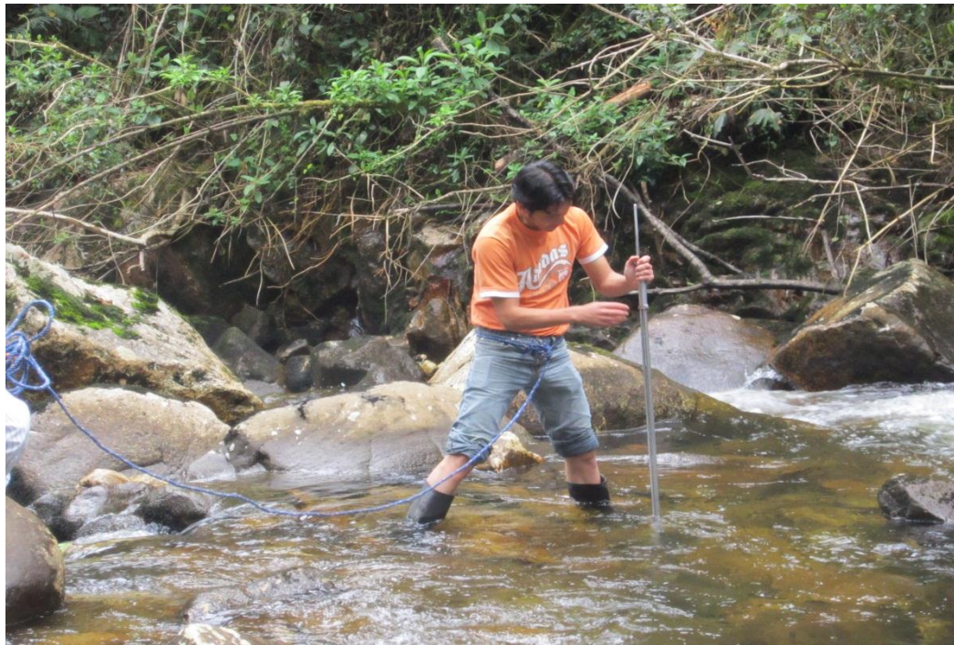
Fotografía 8: Lecturas de Caudal en el Dispositivo del Molinete Electrónico
